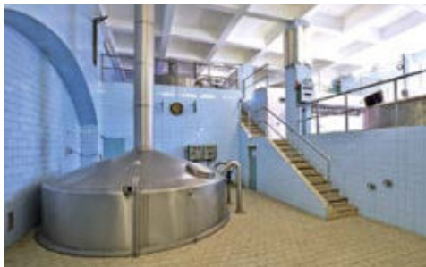
Čtyřnádobová varna se skládá z vystírací kádě, rmutové pánve (kotle), scezovací kádě a mladinové pánve.
